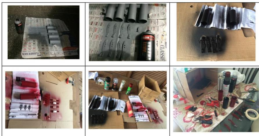
**Figura 12:** Pintura dos suportes de pegada
