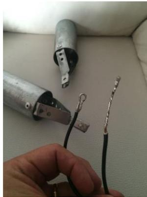
**Figura 11:** Rebite conector-tubo e fio estanhado
