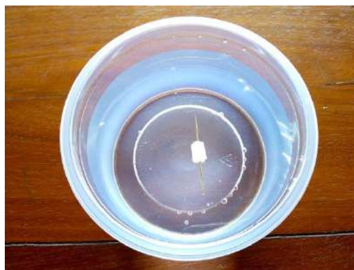
Figura 6.2 – Bússola artesanal para verificar o caráter vetorial tridimensional do campo magnético. Fonte: Arquivos do autor.
