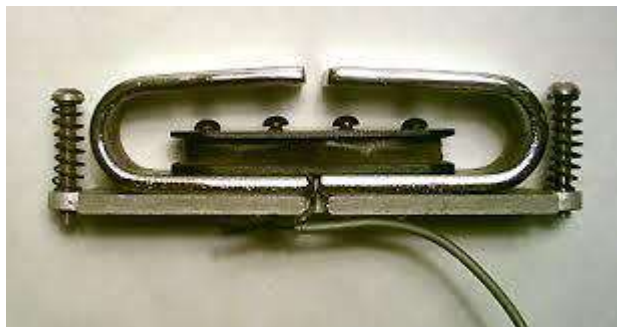
Figura 2.5 – Primeiro modelo de captador eletromagnético. "Ferradura" Rickenbacker. Disponível em: http://www.reidalespaul.com.br/2015/09/historia-dos-captadores-capitulo-1-em.html , acesso em 16/01/2018.
