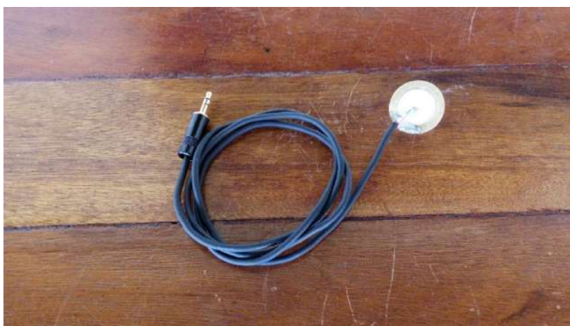
Figura 6.12 – Captador piezoelétrico preparado artesanalmente. Fonte: Arquivos do autor.
