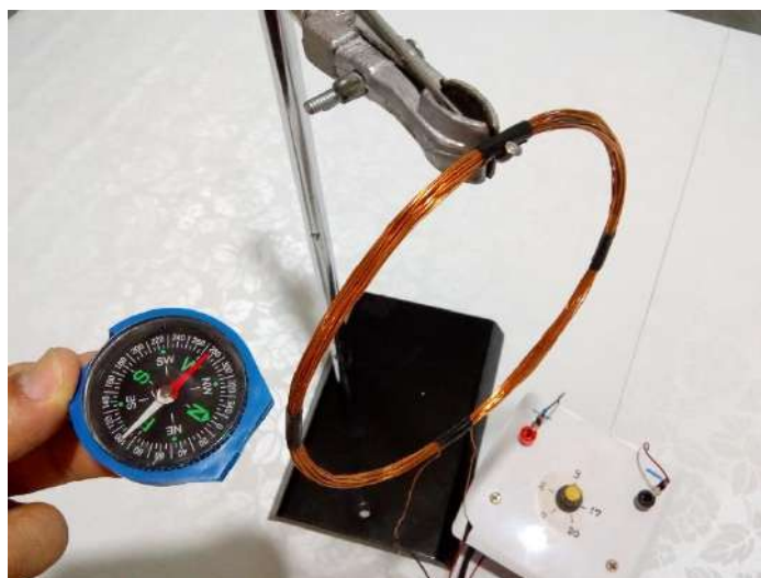
Figura 6.3 – Aparato construído para produzir a rotação de um ímã ao redor de um fio de corrente. Fonte: Arquivos do autor.
