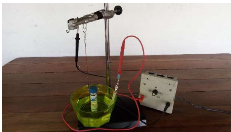
Figura 6.6 – Motor de Faraday em funcionamento. Fonte: Arquivos do autor.
