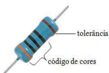
Figura 32 - Resistor de filme metálico. Fonte: Adaptado de [36].
