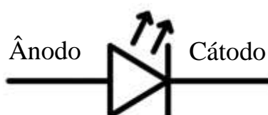
Figura 36 - Representação simbólica de um diodo emissor de luz (LED).
