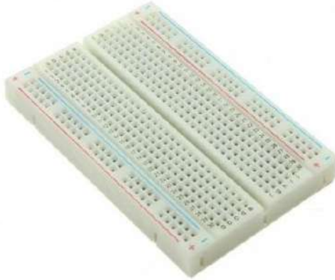
Figura 48 - Protoboard. Placa para montagem de circuitos eletrônicos [93].
