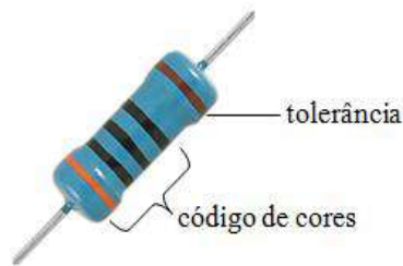
Figura 40 - Resistor de filme metálico. Fonte: Adaptado [86].
