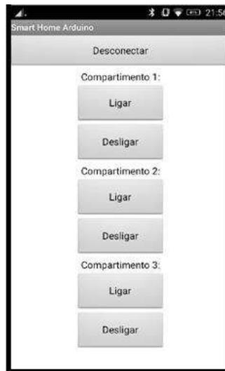
**Figura 11** - Aplicativo *Android* para acionar e desligar as lâmpadas da casa.
