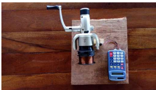
Figura 1.1 – Dispositivo montado para enrolar e contar o número de voltas das bobinas. Fonte: Arquivos do autor.
