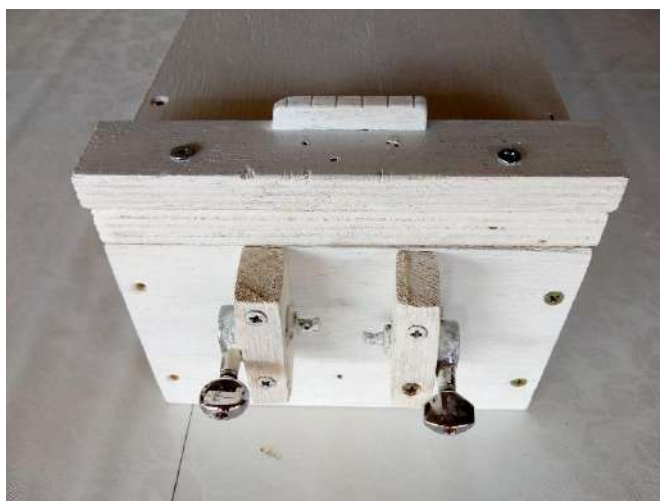
Figura 1.11 - Local de fixação das tarraxas. Fonte: Arquivos do autor.
